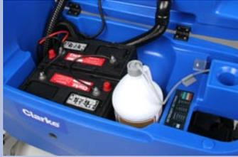
El fácil acceso al compartimiento de la batería es muy conveniente para el mantenimiento y la instalación. Elija baterías 130 Ah húmedas o 114 Ah AGM.
