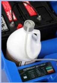
El sistema de mezclado químico opcional dosifica la cantidad apropiada de producto químico y lo mezcla en el flujo de solución. Un recipiente químico de galón estándar almacena el concentrado químico incorporado. El ajuste de onzas por galón se controla mediante una perilla en el tablero de control.
