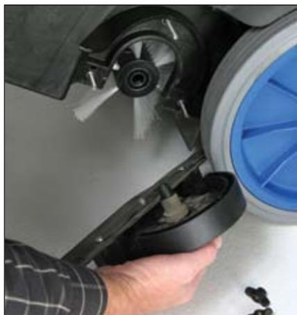
No se necesitan herramientas para cambiar, inspeccionar ni ajustar la escoba principal.
